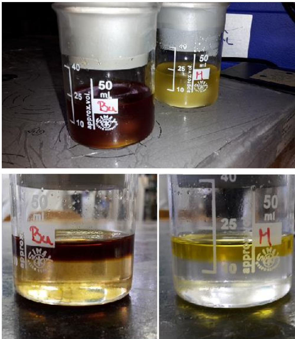
Slika 3.4. Provođenje ekstrakcije bučinog i maslinovog biodizela
