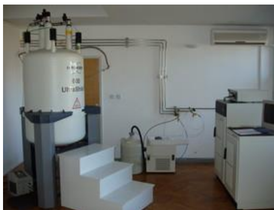
Slika 3.10. Spektrometar NMR Avance 600 Bruker na institutu Ruder Bošković 19
