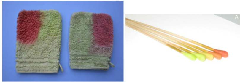
Slika 2.13. pH senzor imobiliziran na tekstil, [32]
