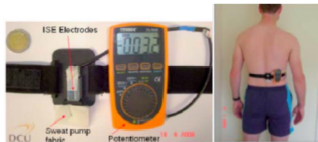
Slika 2.2. Potenciometrijski senzor za natrij, [12]
