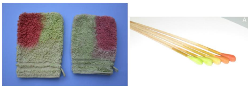
Slika 2.13. pH senzor imobiliziran na tekstil, [32]
