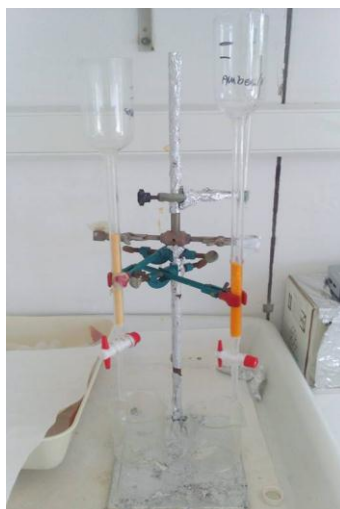
Slika 17. Lijevo na slici je kolona punjena anionskim izmjenjivačem Serdolit™ CG-400 I a desno je kolona punjena anionskim izmjenjivačem Amberlite CG-400
