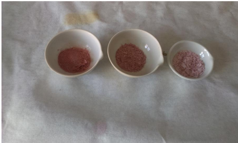
Slika 15. Kompozitni katalizatori s različitim omjerom FeZSM5
