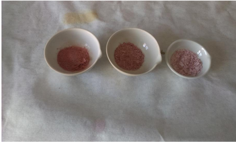
Slika 15. Kompozitni katalizatori s različitim omjerom Fe/ZSM5
