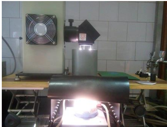
Slika 13. Simulator sunčevog zračenja, Oriel
