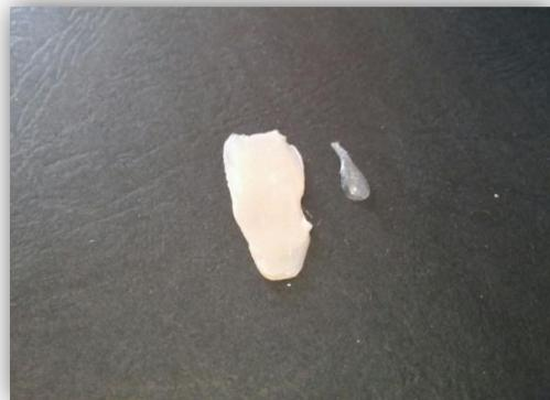
**Slika16.** Pločica Kompozita (A) i Adheziva
