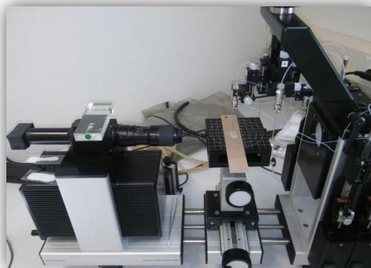
**Slika 17.** Instrument za mjerjenje kontaktnog kuta DataPhysics OCA 20
