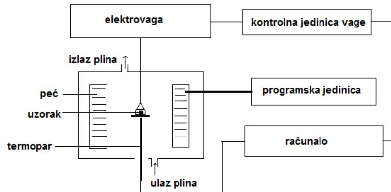
Slika 14. Shema TGA instrumenta [14]
