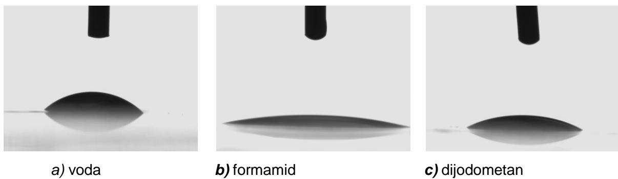
**Slika 24.** Kapljice vode, formamida i dijodometana na pločici Adheziva (B) dobivene mjerjenjem kontaktnog kuta
