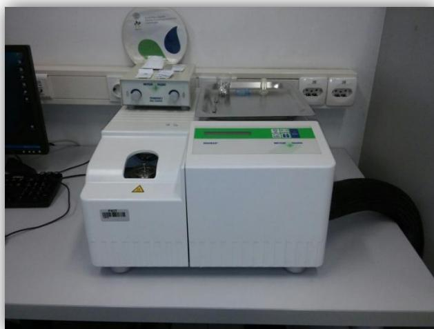
**Slika 19.** Diferencijalni pretražni kalorimetar, Mettler Toledo DSC 823e
