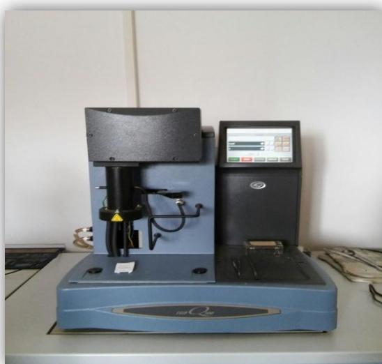
**Slika 20.** Termogravimetar, TA Instruments Q500
