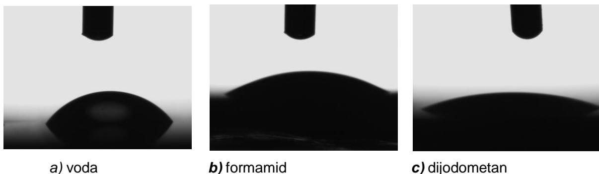
**Slika 23.** Kapljice a) vode, b) formamida i c) dijodometana na pločici Kompozita (A) dobivene mjerjenjem kontaktnog kuta
