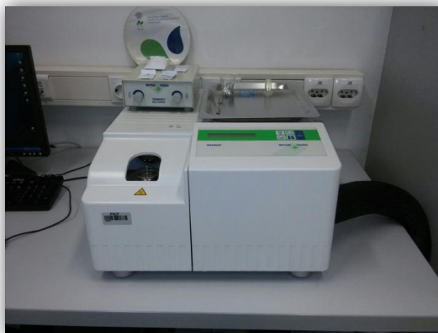
Slika 19. Diferencijalni pretražni kalorimetar, Mettler Toledo DSC 823e
