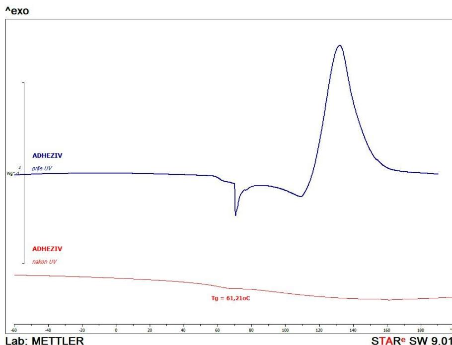
**Slika 26.** DSC termogrami Adheziva (B)
