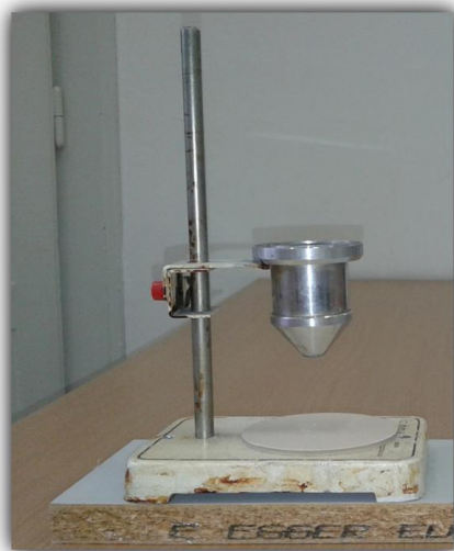
Slika 3.5. Fotografija lijevka za određivanje kuta mirovanja (Fakultet kemijskog inženjerstva i tehnologije, Zavod za mehaničko i toplinsko procesno inženjerstvo, Zagreb, Republika Hrvatska).
