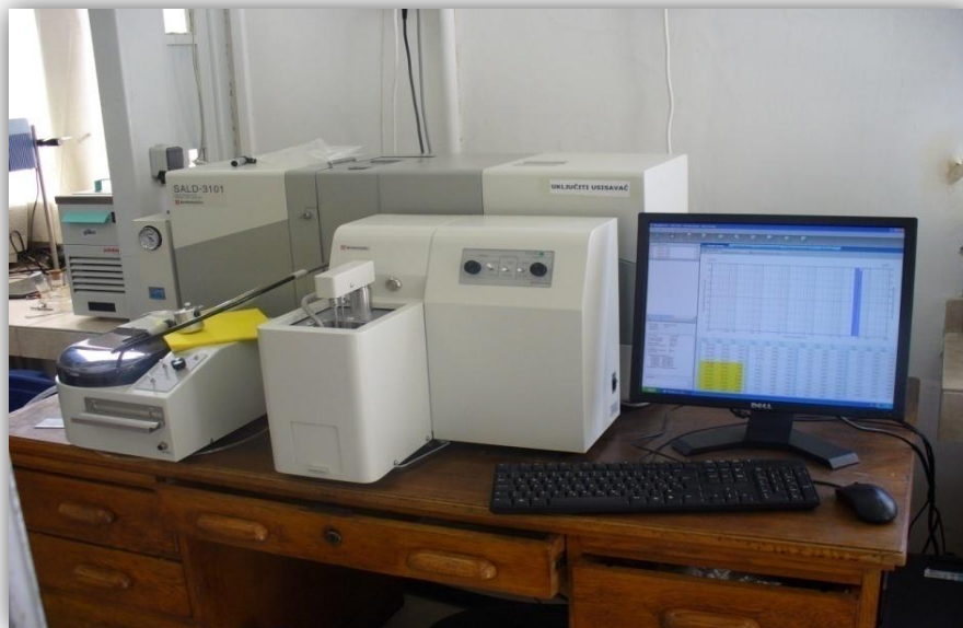
Slika 3.4. Fotografija uređaja za određivanje raspodjele veličina čestica metodom laserske difrakcije SALD-3101 (Shimadzu, Kyoto, Japan) (Fakultet kemijskog inženjerstva i tehnologije, Zavod za mehaničko i toplinsko procesno inženjerstvo, Zagreb, Republika Hrvatska).
