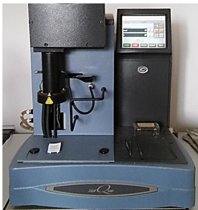
Slika 36. TGA uređaj TA Instruments Q500
