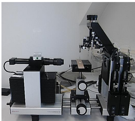
Slika 32. instrument za mjerenje kontaktnog kuta DataPhysics OCA 20
