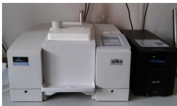
Slika 31. FT-IR spektrometar, Perkin Elmer Spectrum One Spectrometer
