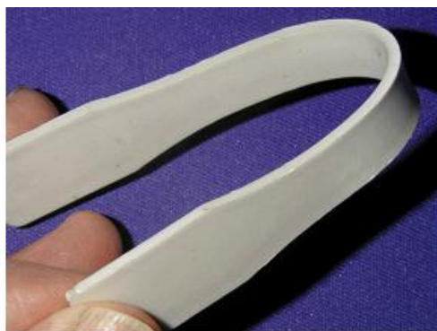
Slika 18. Dodatkom 0,5% KR TTS titanata, fleksibilnost \text{CaCO}_3 uz homopolimer polipropilen kao punilo, povećava se za 70% 7
