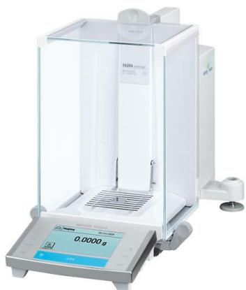
**Slika 3.2** Analitička vaga Mettler Toledo XA105DU [18]
