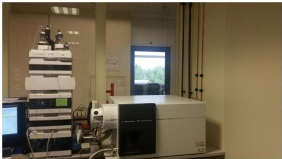
**Slika 3.4** Tekućinski kromatograf UHPLC Agilent Series 1290
