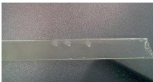
Slika 29. Prikaz reakcije kapljice vode na uzorku PLA DAMO
