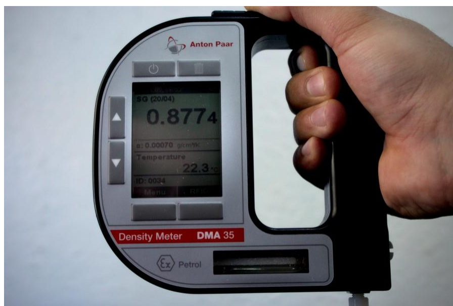
Slika 7. Korištena aparatura za mjerenje gustoće
