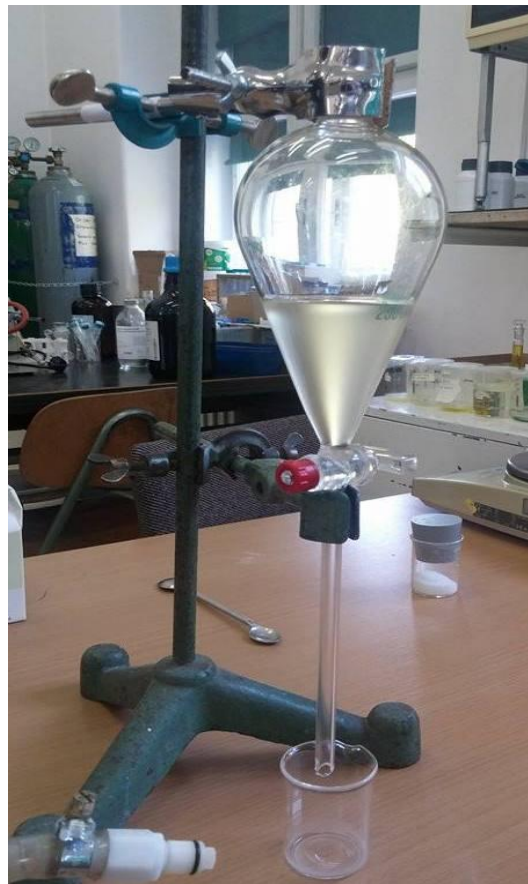
Slika 25. Separacija biodizela i glicerola u lijevku za odjeljivanje
