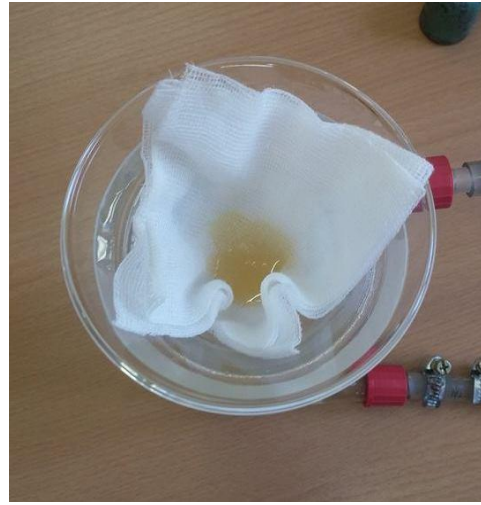
Slika 24. Uklanjanje glicerola filtracijom
