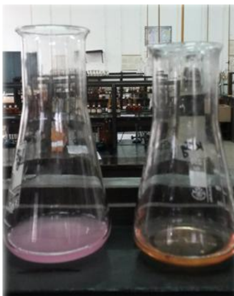
Slika 30. Određivanje kiselinskog broja
