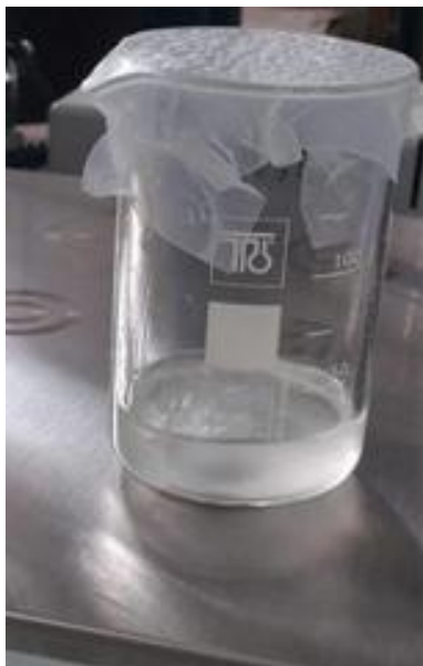
Slika 22. Otapanje NaOH u metanolu
