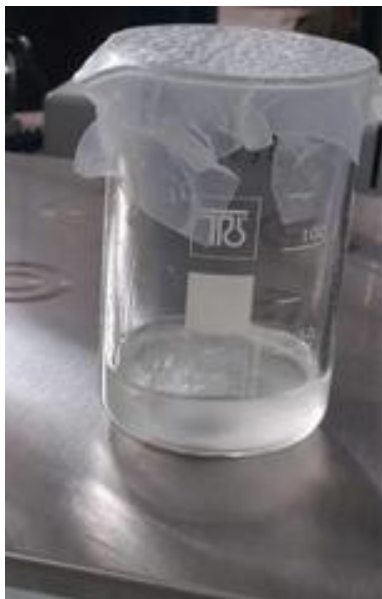
Slika 22. Otapanje NaOH u metanolu
