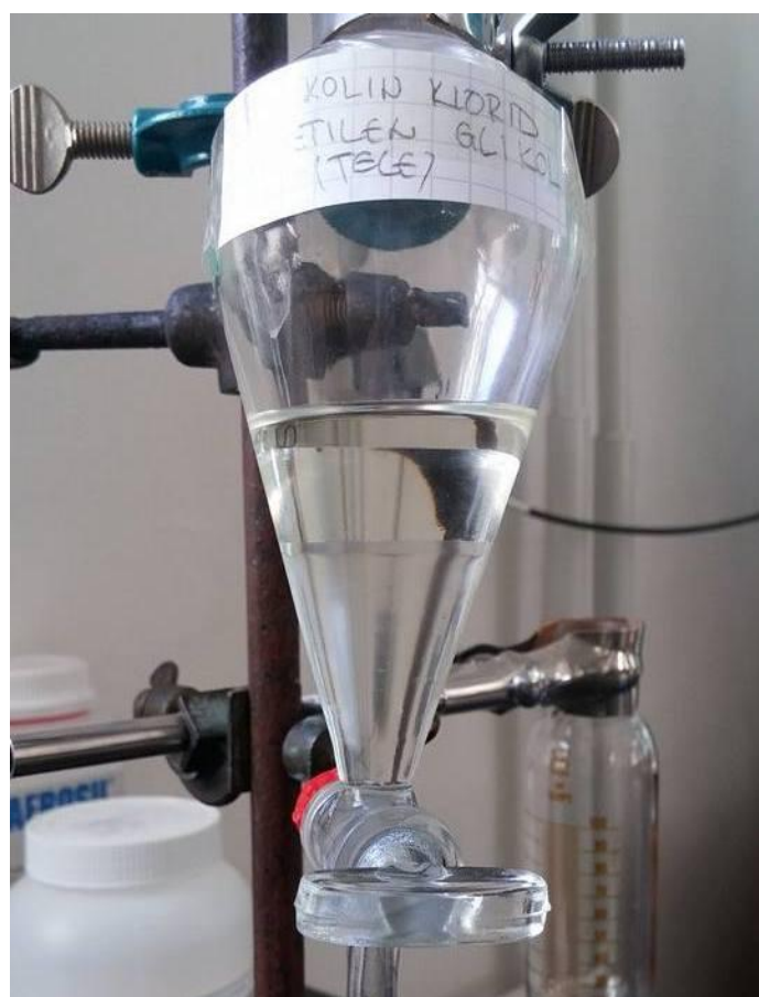
Slika 28. Separacija biodizela i eutektičkog otapala
