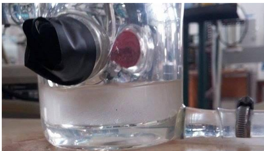
Slika 27. Ekstrakcija glicerola iz biodizela
