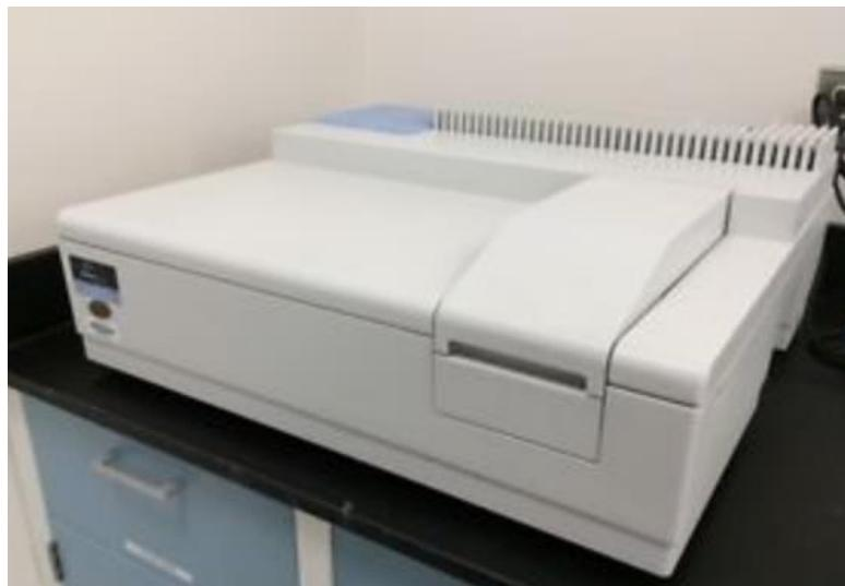
**Slika 18.** UV/VIS spektrofotometar [10]
