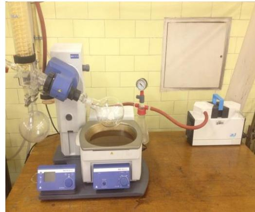
**Slika 9.** Vakuum isparivač
