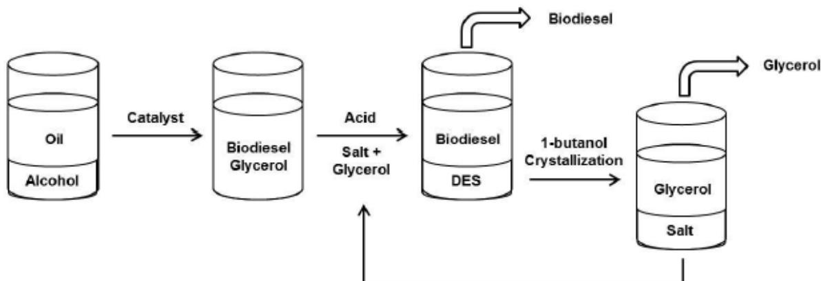
**Slika 7.** Shematski prikaz uklanjanja glicerola u proizvodnji biodizela [2]
