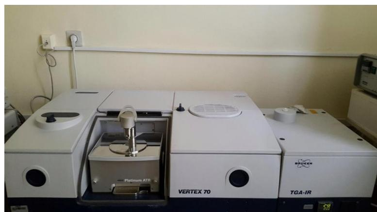
**Slika 17.** Infracrveni spektrofotometar s Fourierovom transformacijom signala (FTIR) [10]
