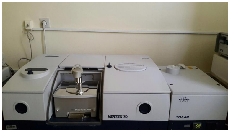
Slika 17. Infracrveni spektrofotometar s Fourierovom transformacijom signala (FTIR) [10]
