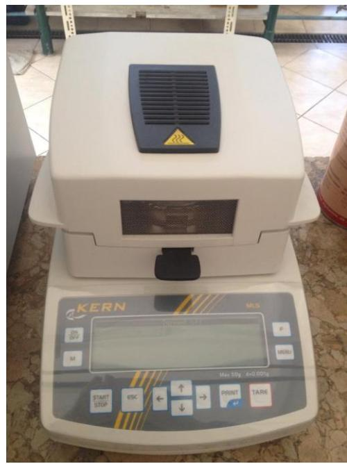
**Slika 16.** Analizator vlage
