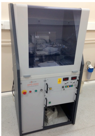
Slika 3.5. Difraktometar APD 2000 proizvođača Ital Structures®.
