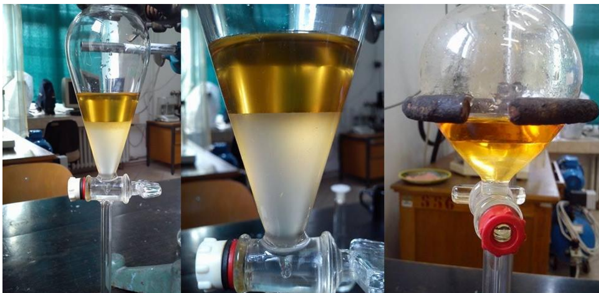
Slika 20. Odjeljivanje faza nakon ekstrakcije
