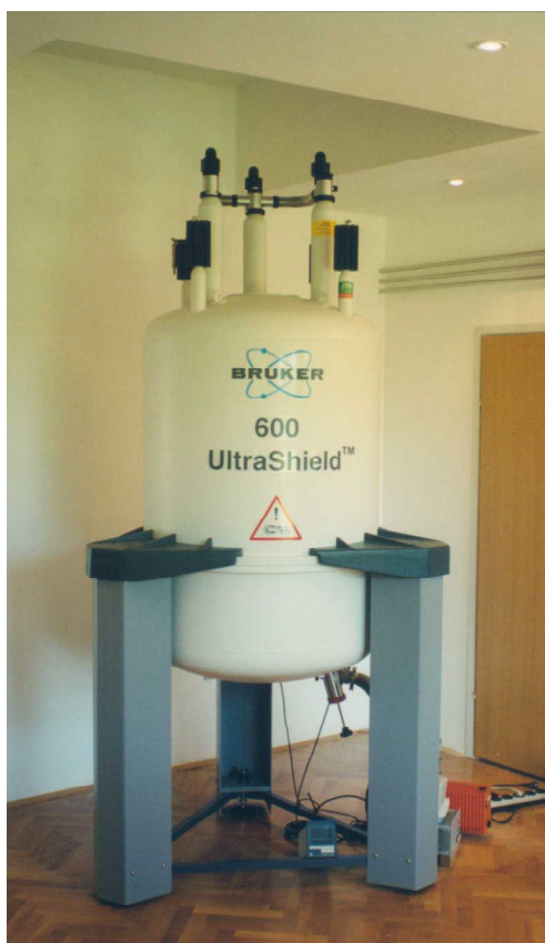
Slika 24. ^1\text{H} NMR spektrometar Bruker Avance 600 na institutu Ruđer Bošković
