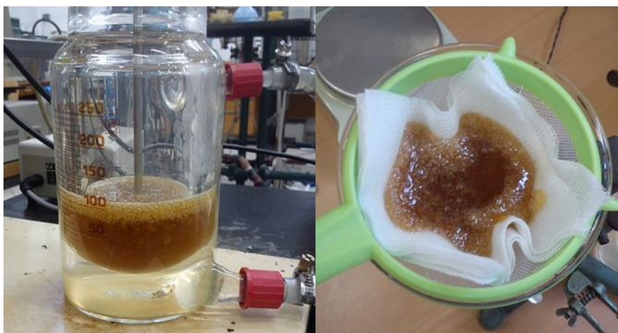
Slika 18. Formiranje i filtracija glicerola nastalog pri sintezi biodizela iz otpadnog ulja.
