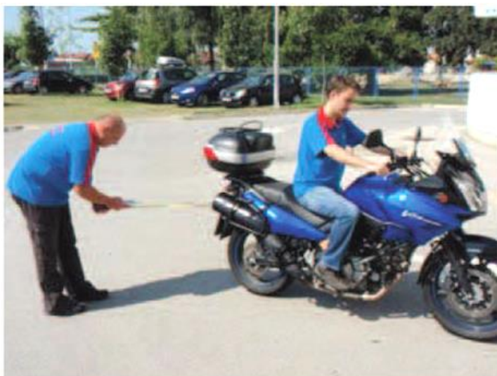
Slika 21. Mjerenje buke kod motocikala. 6
