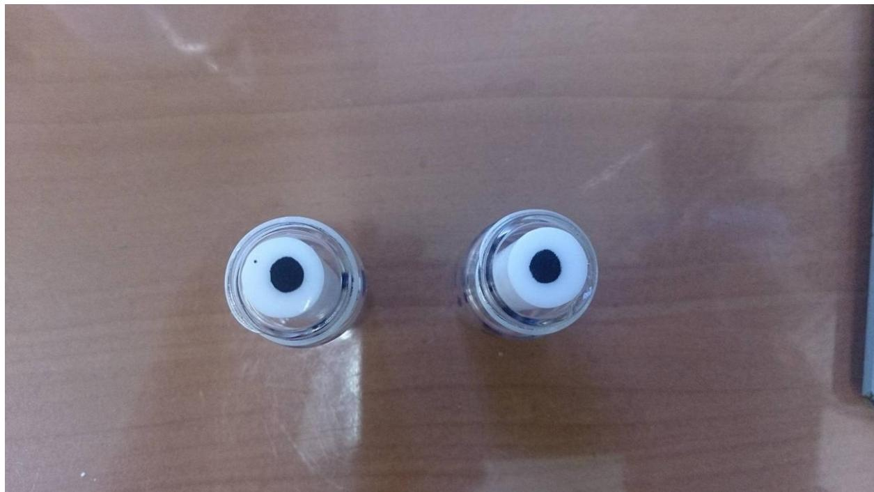
**Slika 3.9.** Disk elektrode na koje je nanesen uzorak rGO
