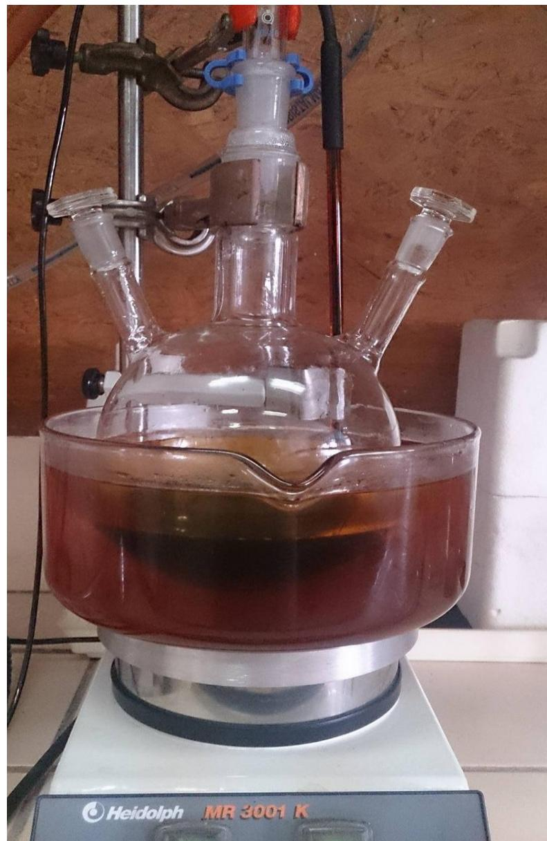
**Slika 3.6.** Aparatura za redukciju GO
