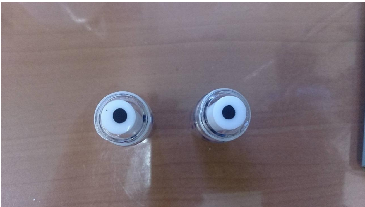
Slika 3.9. Disk elektrode na koje je nanesen uzorak rGO
