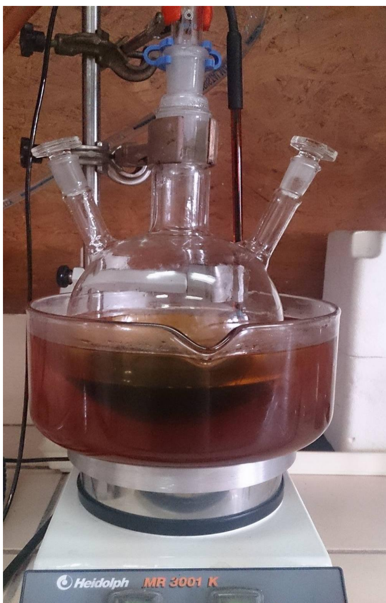
Slika 3.6. Aparatura za redukciju GO
