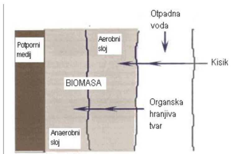
**Slika 9.** Shematski prikaz immobilizirane biomase na filterskoj ispunji
