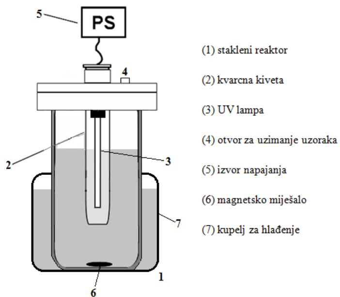
Slika 13. Shema reaktora
