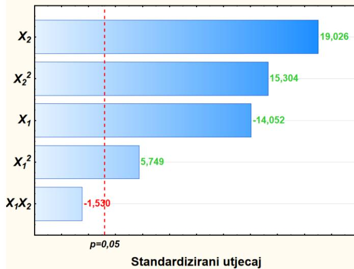
**Slika 15.** Pareto dijagram utjecaja procesnih parametara na učinkovitost UV-C/H<sub>2</sub>O<sub>2</sub> procesa za uklanjanje memantina
