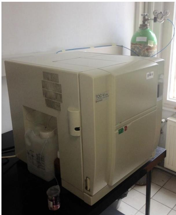
**Slika 12.** Analizator ukupnog organskog ugljika Shimadzu TOC-V
