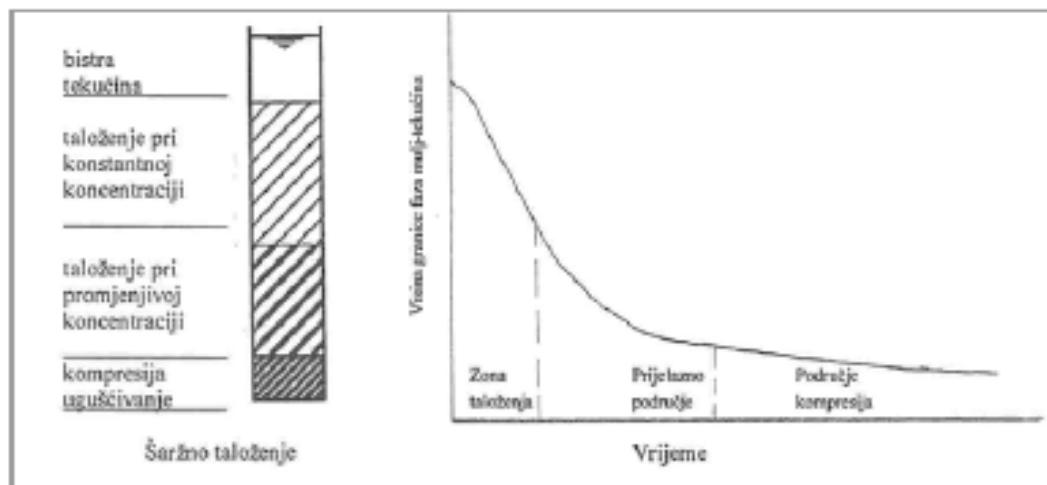
**Slika 5.** Shematski prikaz taloženja čestica pri gravitacijskom ugušćivanju
