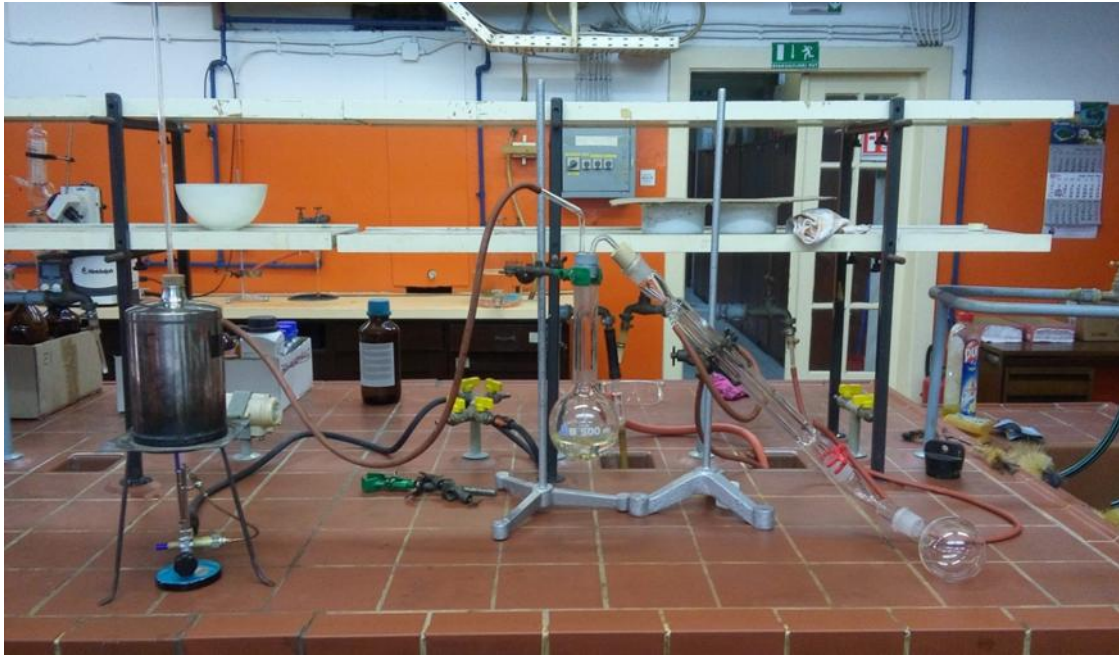
Slika 15. Aparatura za destilacijom vodenom parom
