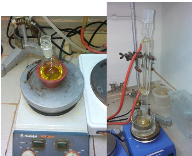
Slika 14. Aparatura za provedbu reakcije pri sobnoj temperaturi (lijevo) i aparatura za refleks (desno)
