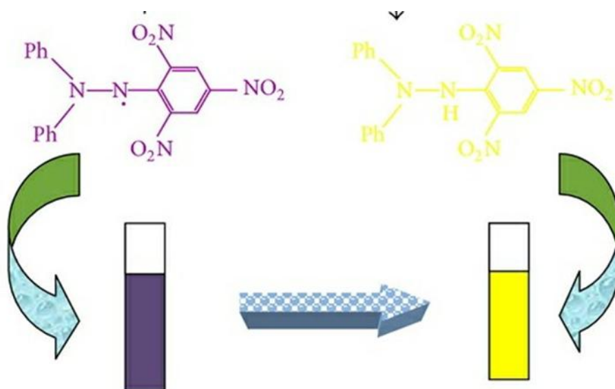
Slika 19. Promjena boje otopine pri doniranju vodikovog atoma sa strane antioksidansa DPPH• radikalu
