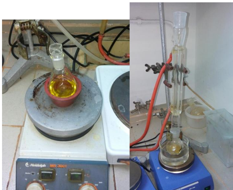
Slika 14. Aparatura za provedbu reakcije pri sobnoj temperaturi (lijevo) i aparatura za refluks (desno)
