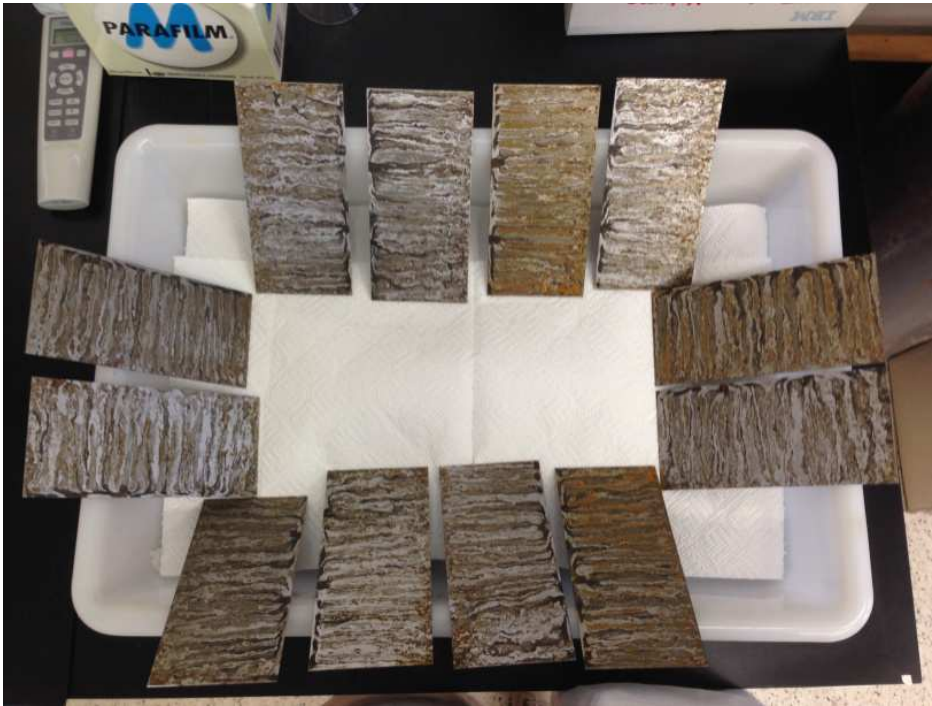
Slika 8. Napolirani uzorci nakon mehaničkog čišćenja
