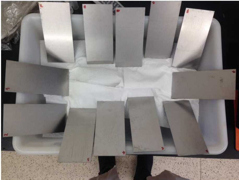
Slika 5. Očišćeni nepolirani uzorci spremni za testiranje
