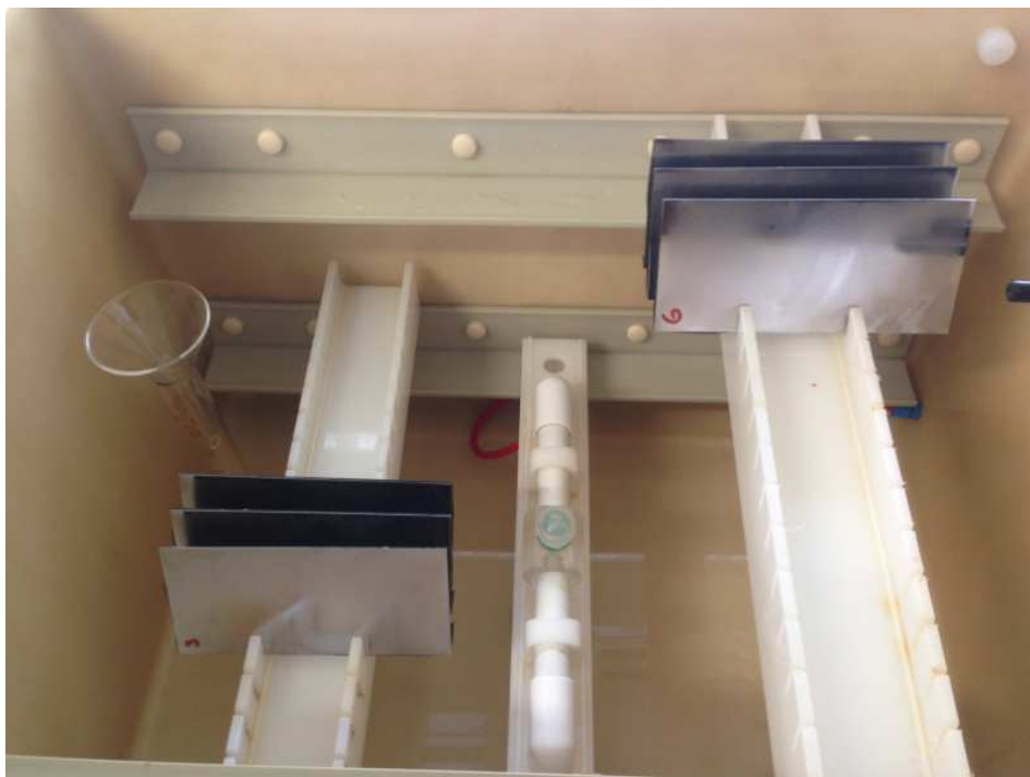
Slika 3. Raspored poliranih uzoraka u komori
