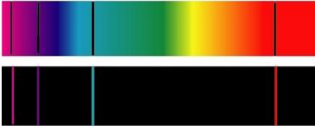
Slika 4. Apsorpcijski spektar: Tamne linije na kontinuiranom spektru, Emisijski spektar: Izolirane svijetle linije
