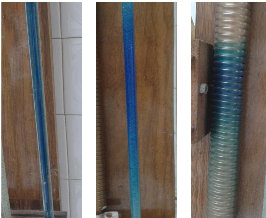
Slika 3.3. Strujanje obojenog trasera u a) ravnoj cijevi, b) ravnoj cijevi sa staklenim kuglicama, c) spiralnoj cijevi
