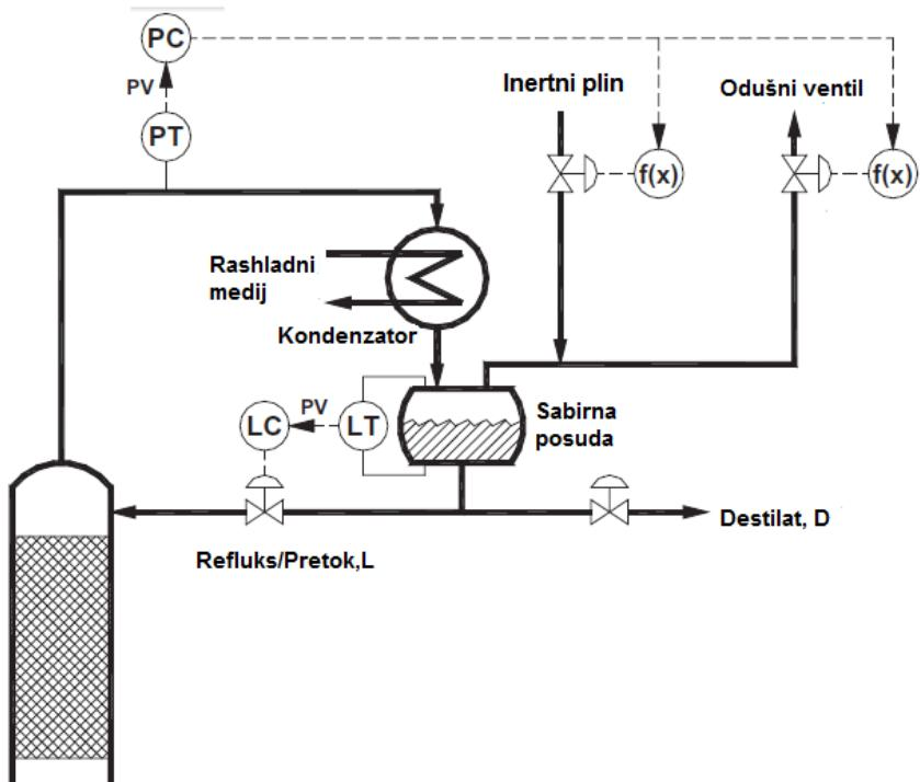
Slika 2.16.- Shematski prikaz regulacije tlaka kod atmosferske destilacije [3]
