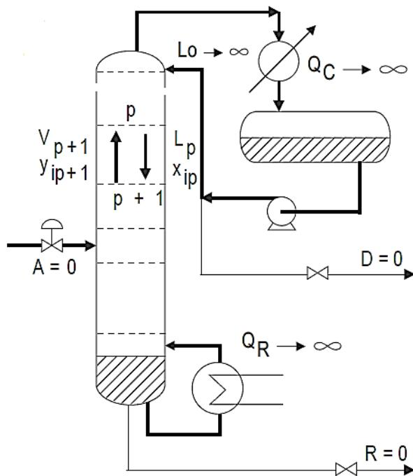
Slika 2.14.- Totalni refluks u destilacijskoj koloni [3]
