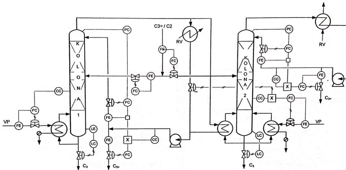
*Slika 2.28. -Regulacijski sustav toplinski integriranih kolona*
