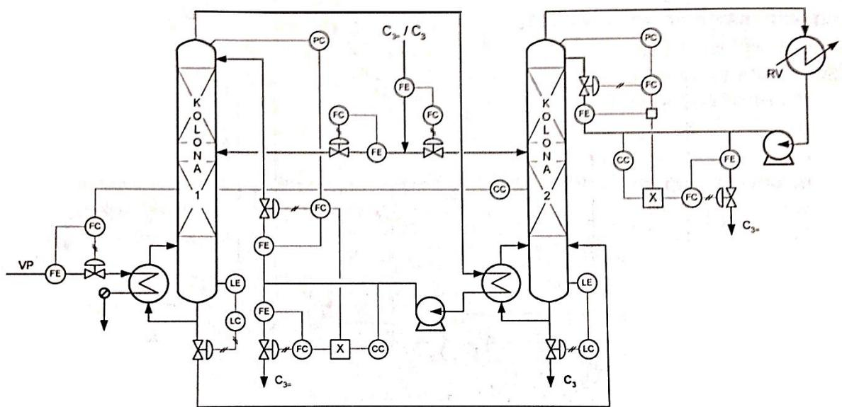
Slika 2.29.-Regulacijski sustav toplinski i materijalno integriranih kolona [1]
