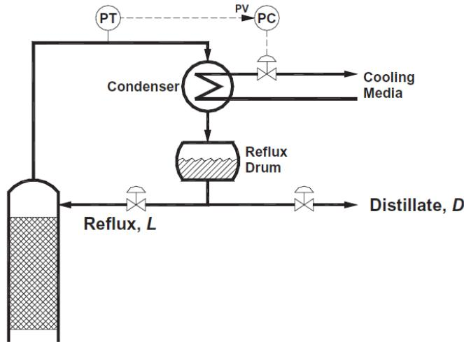
*Slika 2.16 .-Regulacija tlaka oduzimanjem topline u kondenzatoru [3]*
