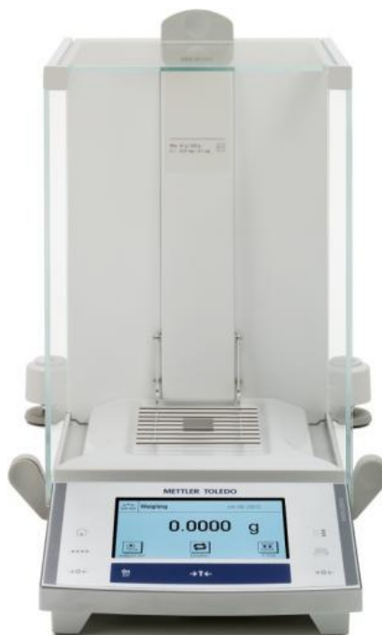
Slika 6. Analitička vaga XS204 DeltaRange, Mettler Toledo 15
