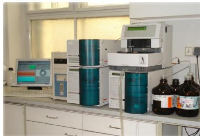
**Slika 10.** Tekućinski kromatograf visoke djelotvornosti, Varian ProStar 500, s detektorom s nizom dioda (HPLC - DAD)
