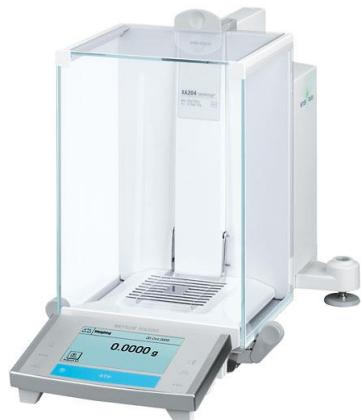
**Slika 9.** Analitička vaga Mettler Toledo XA105DU
