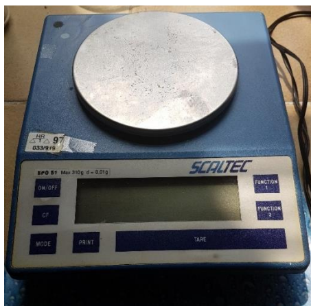
Slika 8. Tehnička vaga Scaltec SP0 51
