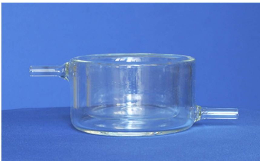
Slika 14. Šaržni reaktor s vodenim hlađenjem
