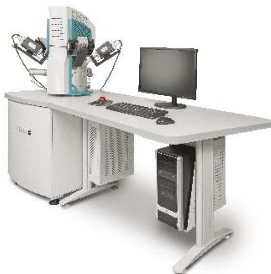
Slika 13. Pretražni elektronski mikroskop, Tescan VEGA 3 SEM
