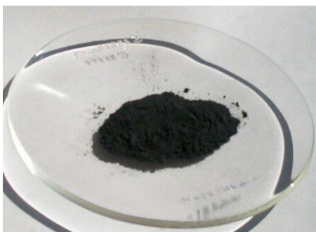
Slika 3.2. Praškasti MnO x katalizator
