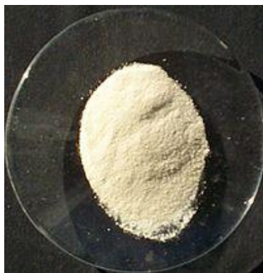
Slika 3.4. Praškasti \text{CeO}_2 katalizator
