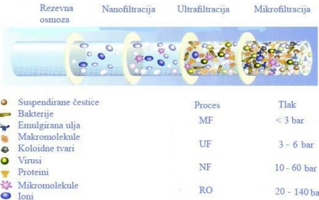
**Slika 9.** Prikaz mogućnosti uklanjanja pojedinih onečišćenja za različite vrste filtracija [18]
