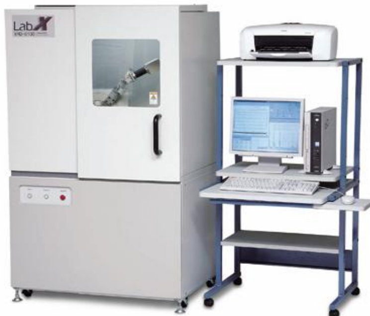
Slika 12. Difraktometar Shimadzu XRD 6000 (26)
