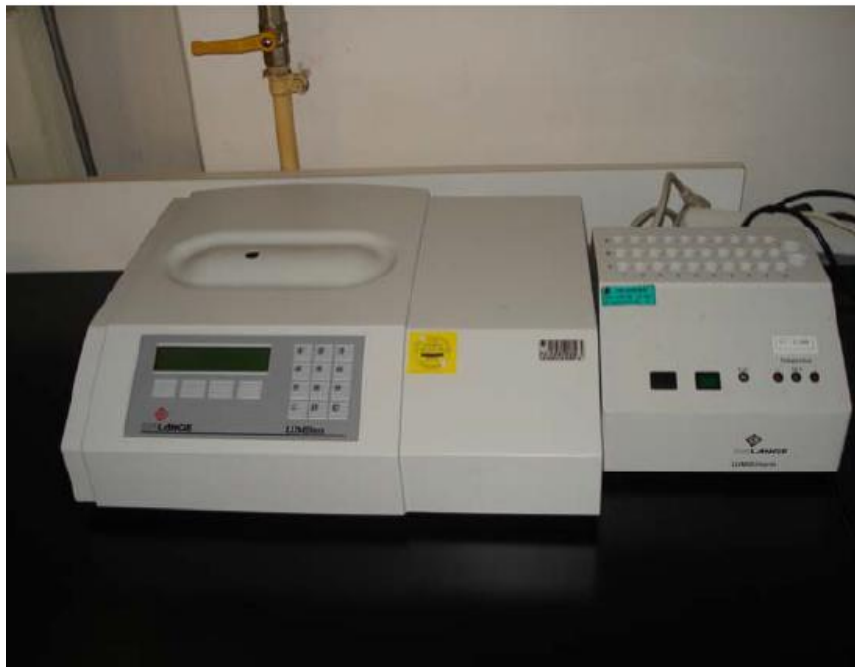
Slika 9. Uređaj za provedbu toksičnosti (LUMIStox 300)
