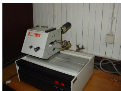
**Slika 16.** Dinamičko mehanički analizator 983,TAInstruments
