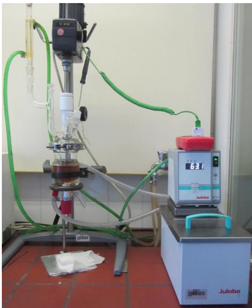
Slika 12 – Provedba preliminarnih ispitivanja u reaktoru od 100mL [30]
