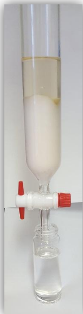
Slika 8. Uklanjanje inhibitora dodecil-metakrilata adsorpcijom u koloni
