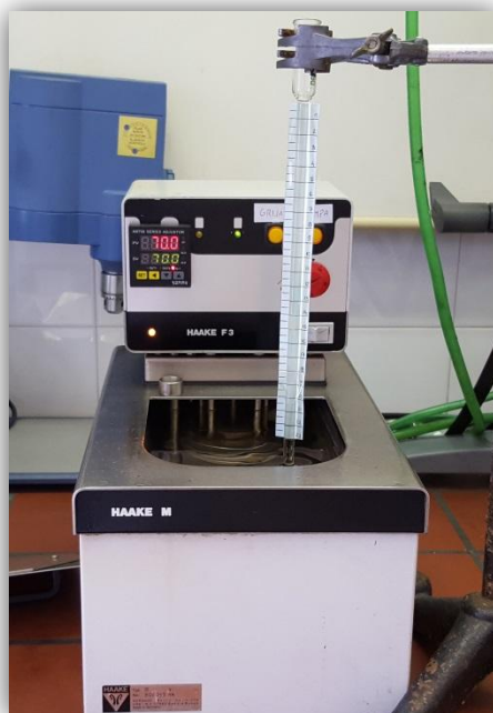
Slika 12. Prikaz reaktora u kojeg je uronjen dilatometer
