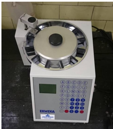
Slika 12. Uređaj za ispitivanje tvrdoće i dimenzija tablete
