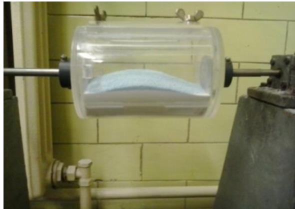
Slika 6. Cilindrična miješalica za praškaste materijale
