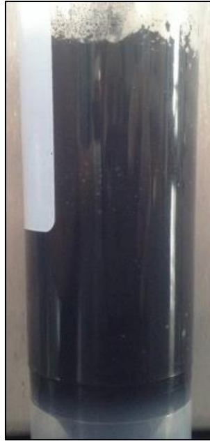
Slika 20. Suspenzija ChCl:Ma 30% H 2 O s nanočesticama CNT volumnog udjela 0,3%
