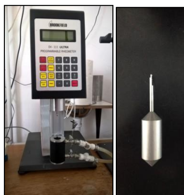
Slika 10. a) Rotacijski viskozimetar Brookfield DV – III ULTRA , b) vreteno SC4-21
