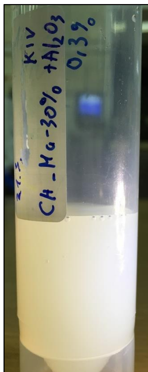
Slika 16. Suspenzija ChCl:Ma 30% H 2 O s nanočesticama Al 2 O 3 (0,3%)
