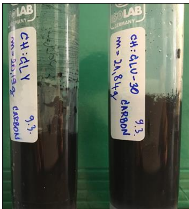
Slika 18. Nanosuspenzije ChCl:Gly i ChCl:Glc 30% H 2 O s ugljikovim nanocjevčicama volumnog udjela 0,3%
