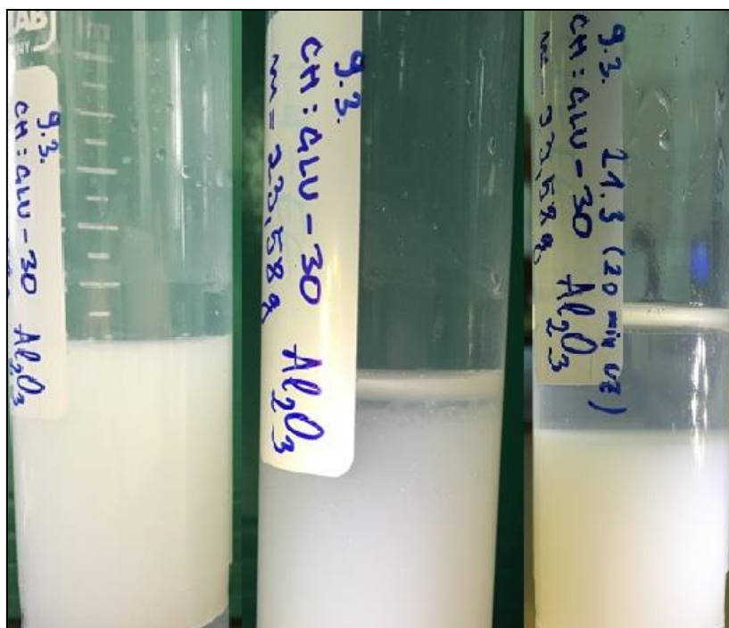
Slika 14. Praćenje stabilnosti suspenzije ChCl:Glc 30% H 2 O s nanočesticama Al 2 O 3 (0,3vol%) na dan pripreme, prvo jasno uočavanje taloga i sedmi dan nakon uočavanja taloga
