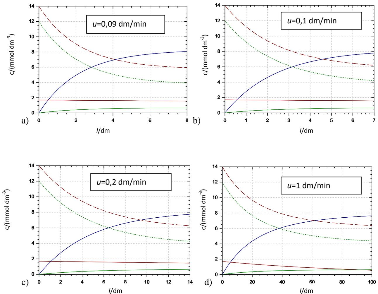
Slika 14. Grafički prikaz simulacija za reakciju aldolne adicije u cijevnom reaktoru, promjena koncentracija *N*-Cbz-3-aminopropanala, dihidroksiacetona, enzima FSA A129G, te konverzije, promjenom duljine reaktora, uz nestabilan enzim ( $k_d=0,011\text{min}^{-1}$ ), pri različitim linearnim brzinama, uz nestabilan enzim ( $k_d=0,011\text{min}^{-1}$ )
