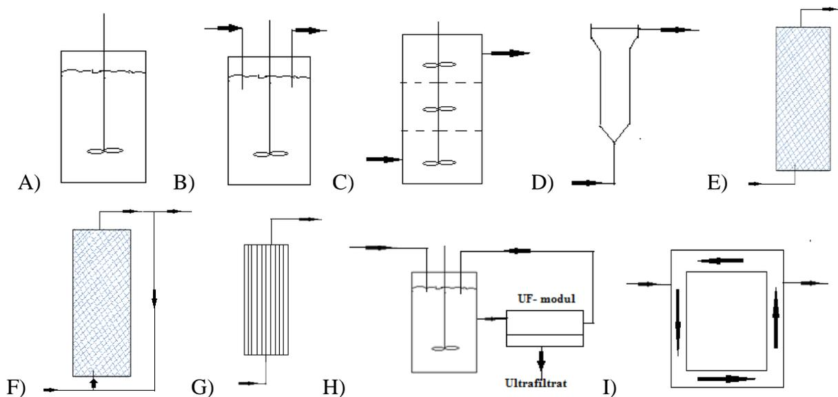
Slika 9. A) Punidbeni bioreaktor s mješalom B) Kontinuirani s mješalom C) Višestupanjski sustav miješanja D) s lebdećim slojem E) s nasutim slojem F) s nasutim slojem i i reciklacijom G) cijevni H) s mješalom i ultrafiltrom I) cijevni s kružnom reciklacijom
