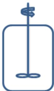
Slika 6. Kotlasti reaktor
