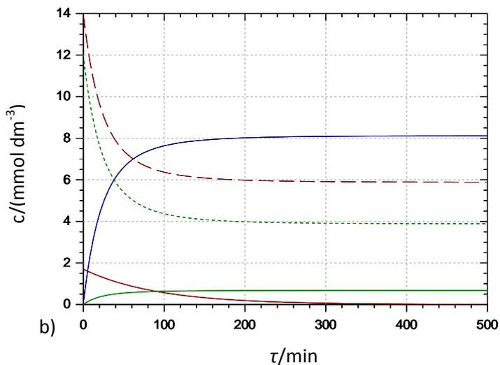
Slika 12. Grafički prikaz simulacija za reakciju aldolne adicije u cijevnom reaktoru, promjena koncentracija *N*-Cbz-3-aminopropanala, dihidroksiacetona, enzima FSA A129G, te konverzije, promjenom vremena zadržavanja, uz nestabilan enzim ( $k_d=0,011\text{min}^{-1}$ ), pri maksimalnim vrijednostima vremena zadržavanja 100 min i 500 min
