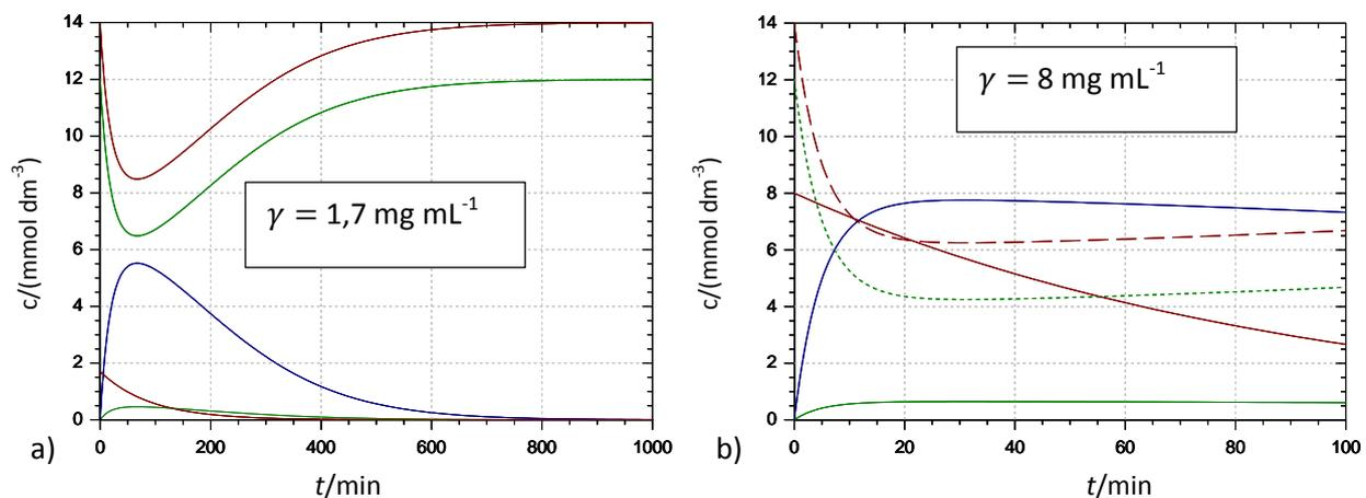
Slika 15. Grafički prikaz simulacija za reakciju aldolne adicije u protočno kotlastom reaktoru, promjena koncentracija *N*-Cbz-3-aminopropanala, dihidroksiacetona, enzima FSA A129G, te konverzije, s vremenom, uz nestabilan enzim ( $k_d=0,011\text{min}^{-1}$ ), pri različitim koncentracijama enzima, uz nestabilan enzim ( $k_d=0,011\text{min}^{-1}$ )
