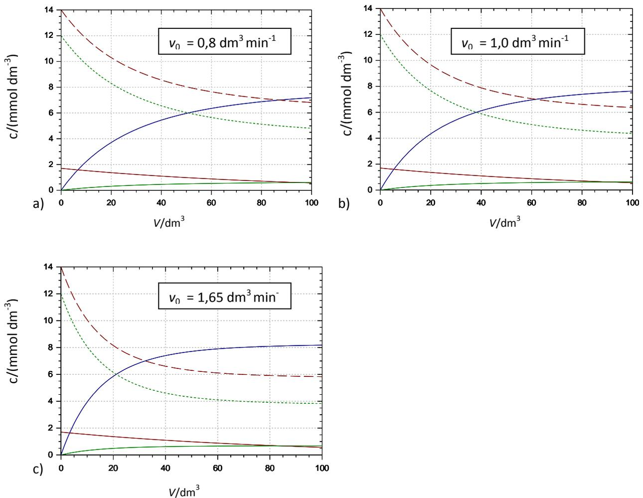
Slika 13. Grafički prikaz simulacija za reakciju aldolne adicije u cijevnom reaktoru, promjena koncentracija *N*-Cbz-3-aminopropanala, dihidroksiacetona, enzima FSA A129G, te konverzije, promjenom volumena, uz nestabilan enzim ( $k_d=0,011\text{ min}^{-1}$ ), pri maksimalnoj vrijednosti volumena  $100 \text{ dm}^3$ , pri različitim vrijednostima protoka, uz nestabilan enzim ( $k_d=0,011\text{ min}^{-1}$ )
