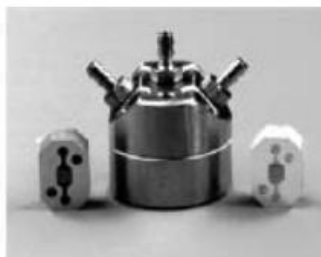
Slika 10. Mikromiješalo izrađen od nehrđajućeg čelika i drugih metala [7]
