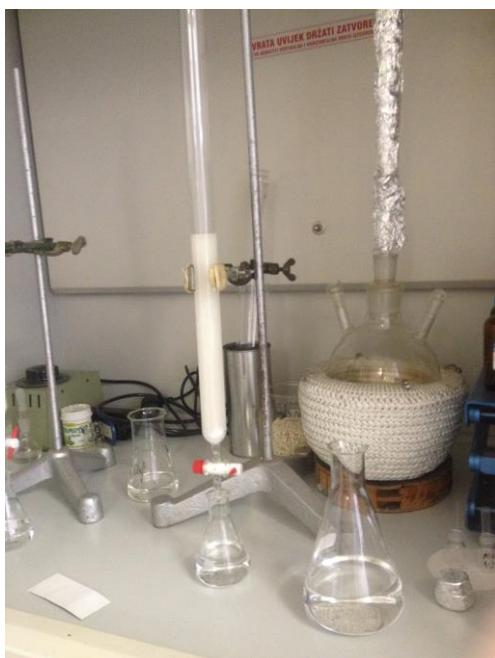
**Slika 1:** Aparatura za kolonsku kromatografiju
