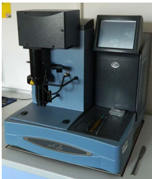
Slika 3.4.1. Termogravimetar TA Instruments Q500
