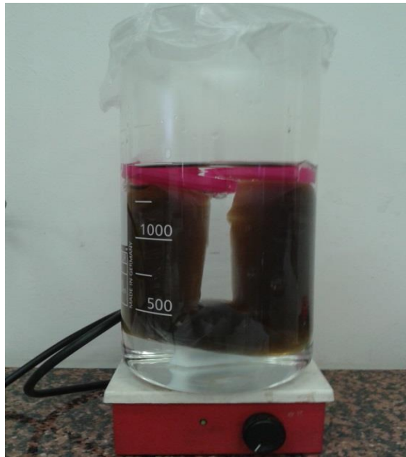
Slika 3.1.2. Dijaliza otopine grafenovog oksida
