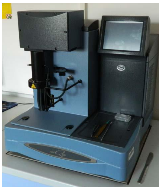
Slika 3.4.1. Termogravimetar TA Instruments Q500
