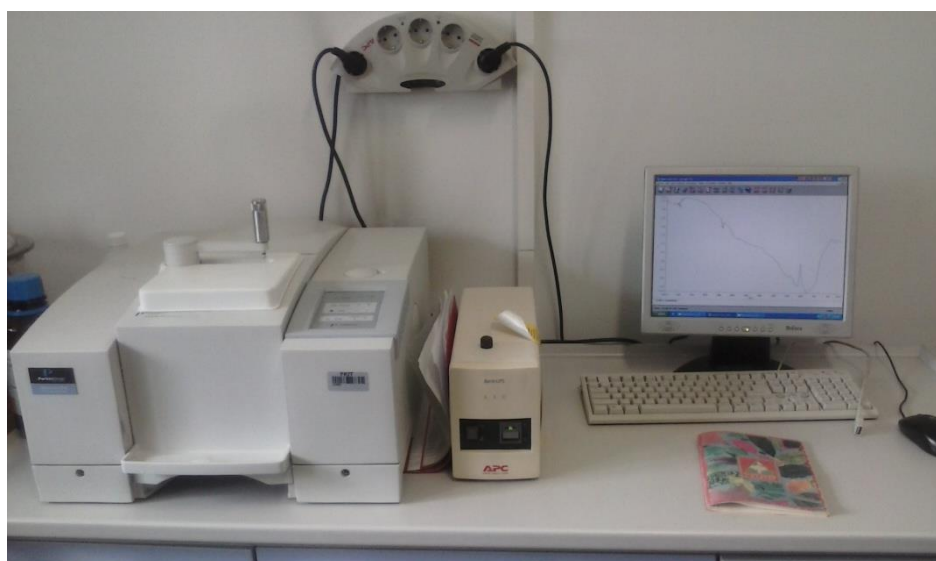
Slika 3.6.1. FT-IR spektrofotometar Perkin Elmer Instruments, Spectrum One, povezan s računalom
