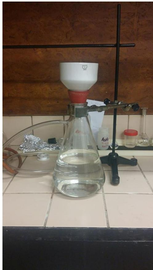
**Slika 3.6.** Filtriranje rGO kroz Buchnerov lijevak
