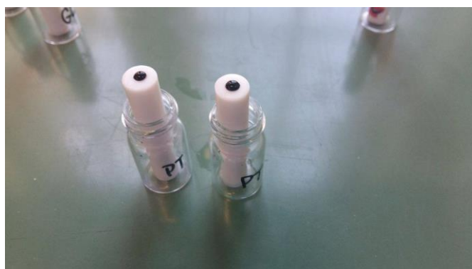
Slika 3.10. Disk elektrode na koje je nanesen uzorak rGO
