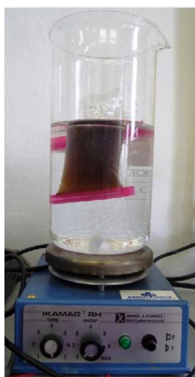
Slika 3.1. Dijaliza otopine grafenova oksida
