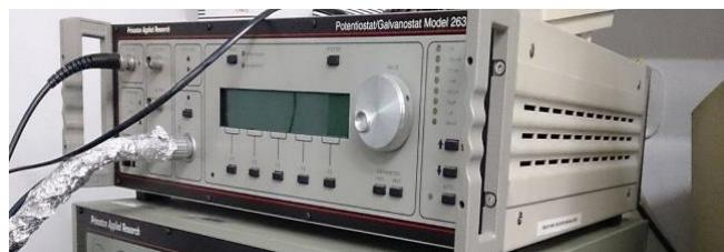
**Slika 3.8.** Potencijostat EG&G Princeton Applied Research, model 263A
